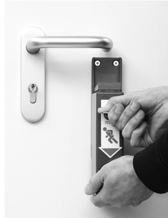
Mit dem Geräteschlüssel wird der GfS EH-Türwächter – durch Verschieben nach unten – alarmfrei in eine Dauerfreigabeposition gebracht werden. In dieser Position ist die Tür normal begehbar. Ein Daueroffenkontakt ist auf Wunsch möglich.
