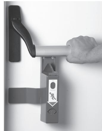
Beim Durchdrücken des Stangengriffes schiebt sich der GfS EH-Türwächter nach unten und ermöglicht in nur einem Öffnungsvorgang das Begehen der Notausgangstür. Dabei wird Daueralarm ausgelöst, der nur mit dem Geräteschlüssel gelöscht werden kann.
