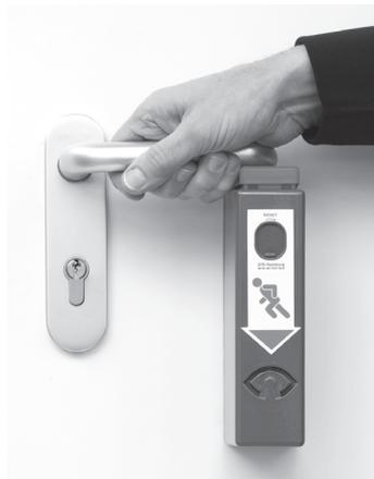
Bei leichtem Drücken der Türklinke ertönt Alarm. Sobald die Klinke losgelassen wird, verstummt der Alarm wieder. Wird die Klinke jedoch komplett heruntergedrückt, wird der Daueralarm ausgelöst.
