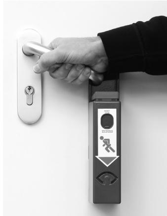
Beim Durchdrücken der Türklinke verschiebt sich der GfS EH-Türwächter nach unten und ermöglicht in einem Öffnungsvorgang das Begehen der Notausgangstür. Dabei wird Daueralarm ausgelöst, der nur mit dem Geräteschlüssel zurückgesetzt werden kann.
