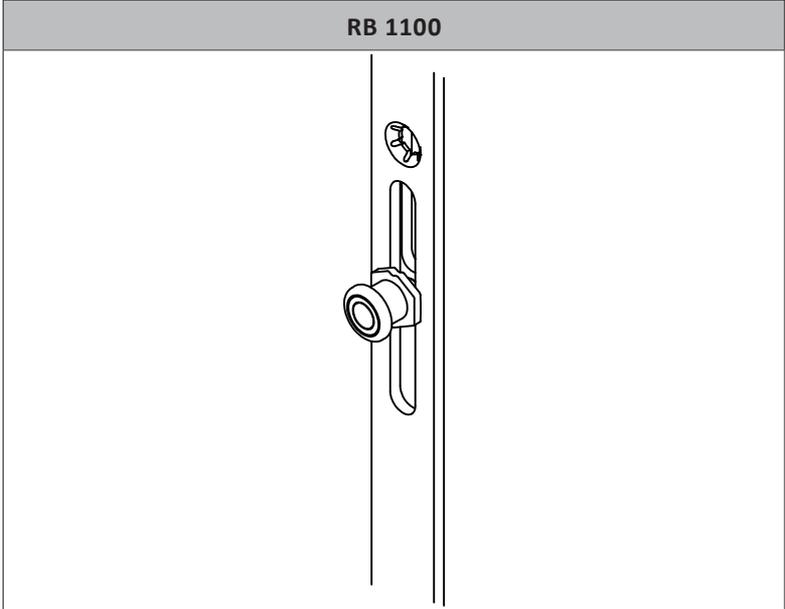
Die Komfortpilzbolzen in Verbindung mit den hochwertigen KfV-Rahmenteilen sorgen für stufenlose Einstellbarkeit des Flügeldrucks sowie automatische Höhenanpassung mit Selbsthemmung (Rückstellverhinderung) zum Ausgleich von Falzlufttoleranzen.
