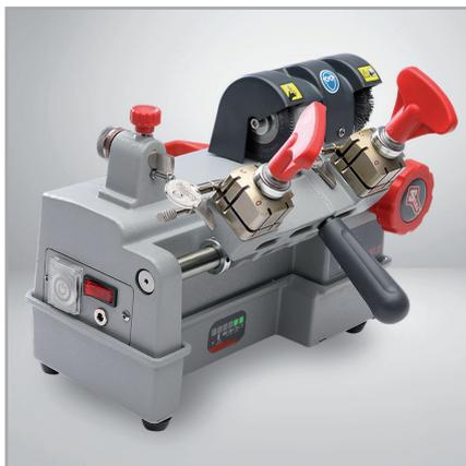
Flash Mobile ist die batteriebetriebene mechanische Fräsmaschine für Flachschlüssel für Zylinderschlösser und Fahrzeuge. Die Maschine kann auch Kreuzbartschlüssel, Schlüssel mit langem Hals, Schlüssel mit Spitzenanschlag und Schlüssel mit Klappmechanismus fräsen.
